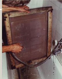
3. Płukanie sita po naświetleniu emulsji
